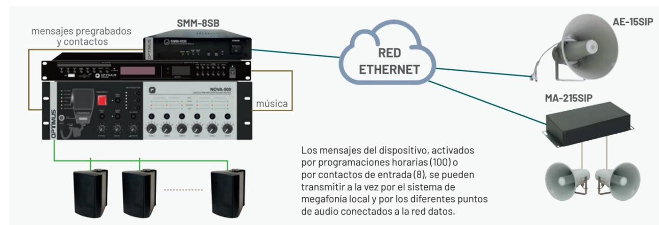
Los mensajes del dispositivo, activados por programaciones horarias (100) o por contactos de entrada (8), se pueden transmitir a la vez por el sistema de megafonía local y por los diferentes puntos de audio conectados a la red datos.
